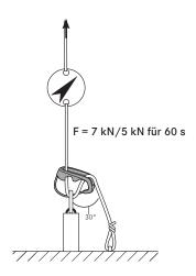
Das Bremsgerät muss mit einer Kraft von 7 kN bei einem Einfachseil (Zwillingsseile: 7 kN im Doppelstrang, Halbseile: 5 kN im Einzelstrang) für eine Dauer von 60 s belastet werden.
