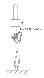
Das Bremsgerät wird durch die zusätzliche Befestigung am Prüfgerät befestigt. Das Seil ist mit dem Prüfgerät durch einen 10 mm Bolzen zu verbinden. Eine Kraft von 8 kN ist für 60 s auf das herauslaufende Seil aufzubringen.
